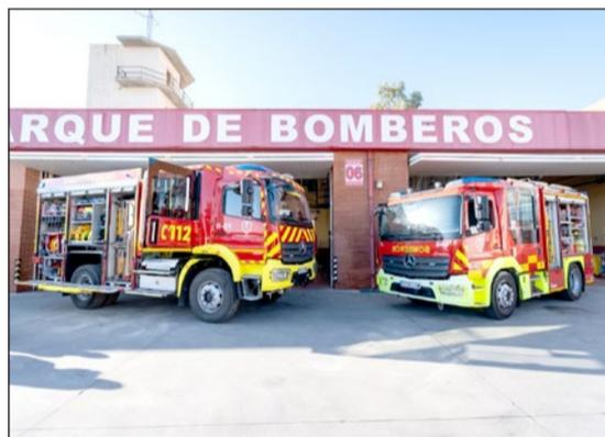
capacidad de cisterna de 1.600 litros y especialmente indicada para la extinción de incendios de viviendas, vehículos y de cualquier otro tipo de siniestro dentro en el núcleo urbano, ya que sus dimensiones le permiten gran movilidad. Cuenta con todo el equipamiento necesario para este tipo de trabajo: ventilación, equipos de iluminación, aseguramiento y mate-
