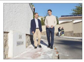
Se ha ampliado la acera hasta los 2.20 metros y sustituido toda la solería antigua por pavimento de adoquín cerámico, así como la modificación e instalación del alumbrado público
